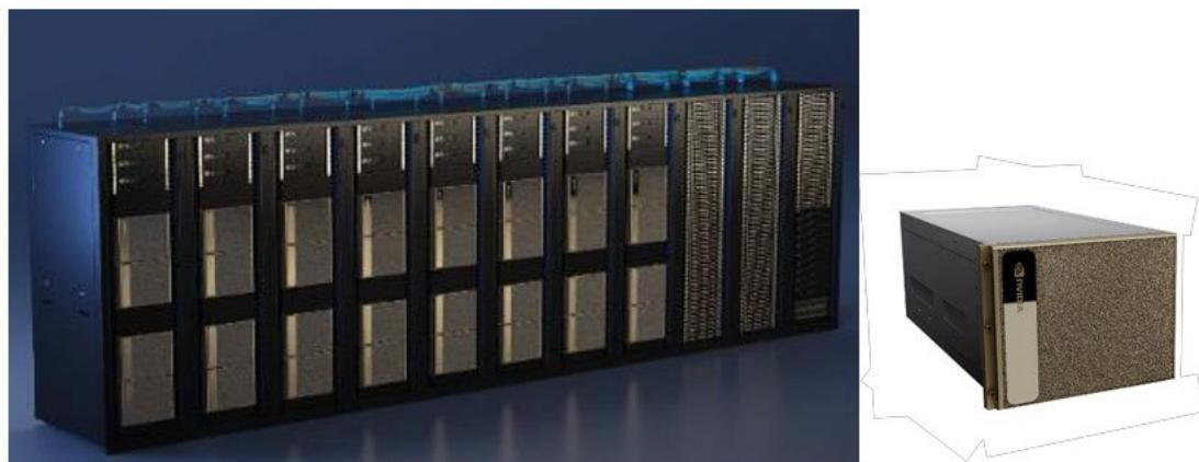
整體依據 NVIDIA DGX SuperPOD (<https://www.nvidia.com/en-us/data-center/dgx-superpod/>)參考架構進行規劃建置，採用 64 台 NVIDIA 最新人工智慧超級電腦 DGX H100 (<https://www.nvidia.com/zh-tw/data-center/dgx-h100/>)，每台 DGX H100 主機具備 8 個 NVIDIA H100 GPU 透過最新一代的 NVLink 以及 NVSwitch 技術進行整合，整體共計 512 個 H100 GPU。DGX 主機內每一 GPU 彼此之間具備 900GB/s 的雙向溝通頻寬，主機與主機之間透過 8 條最新 InfiniBand 技術搭配 NVIDIA Quantum-2 InfiniBand (400Gb/s 高頻寬與低延遲高速網路技術 <https://www.nvidia.com/zh-tw/networking/quantum2/>)進行主機間 GPU 運算溝通，為運用在 AI 運算與 NVIDIA 最新的前瞻技術開發的超級電腦。
