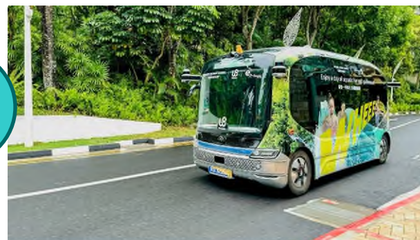
車輛：整合光達、攝影機和感測器， 360度全方位探測200m障礙物
